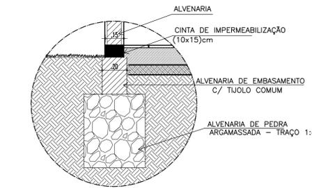
05 DETALHE IMPERMEABILIZAÇÃO PAREDE CHUVEIROS
